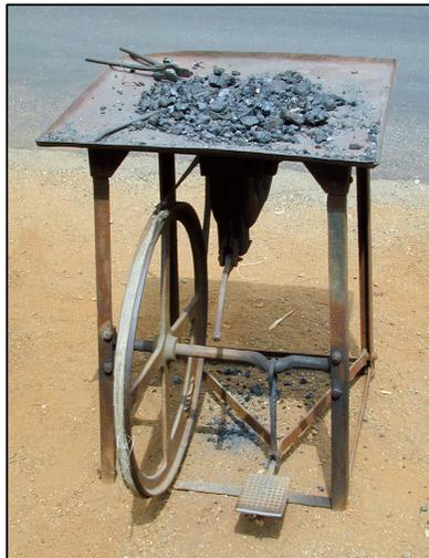
Antica forgia a pedale con la quale si arroventava il ferro sul carbone di legna.
