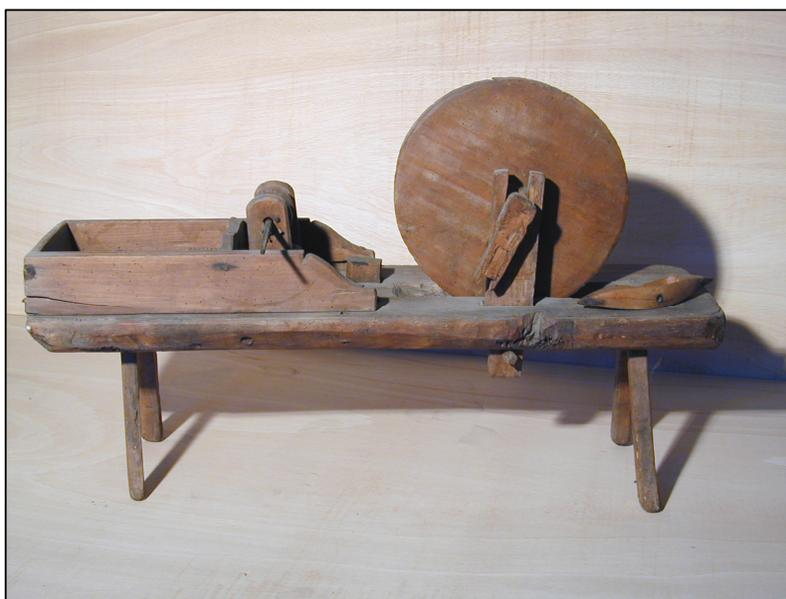
Strumento con il quale si caricavano di filo di canapa le spolette utilizzate poi nel telaio per la tessitura delle pezze di tela.
