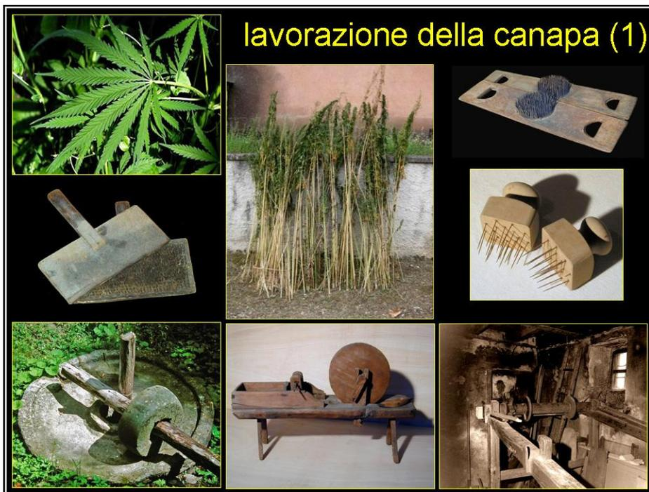
085 – Le prime fasi di lavorazione della canapa prevedevano la raccolta, la legatura in manelli, la macerazione, la stigliatura, il passaggio al frantoio e la filatura.
