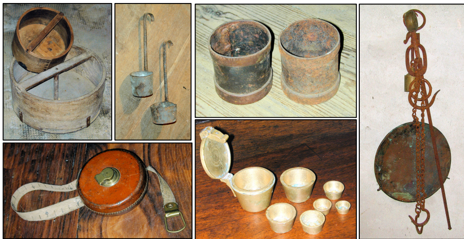
Strumenti di misura. In senso orario: due stèr per granaglie, misurini per l'olio, due 'mezzo litro' di ferro, una grossa stadera, pesi standard incorporabili uno nell'altro.
