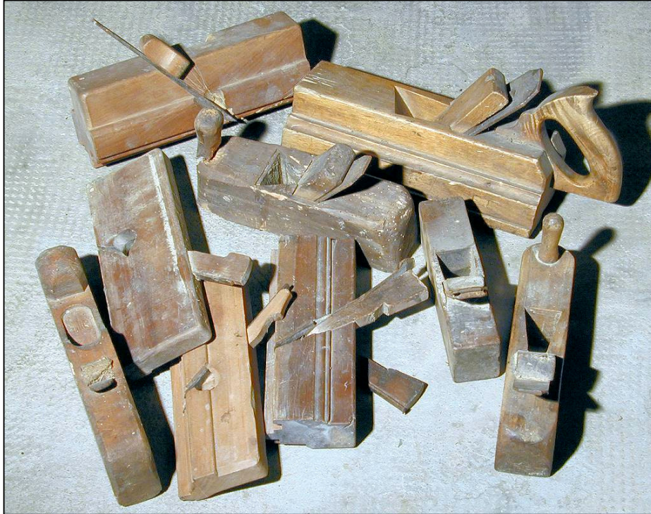
Assortimento di pialle di varie forme e dimensioni, ciascuna con la sua specifica funzione, provenienti da un laboratorio di falegnameria del XIX secolo.
