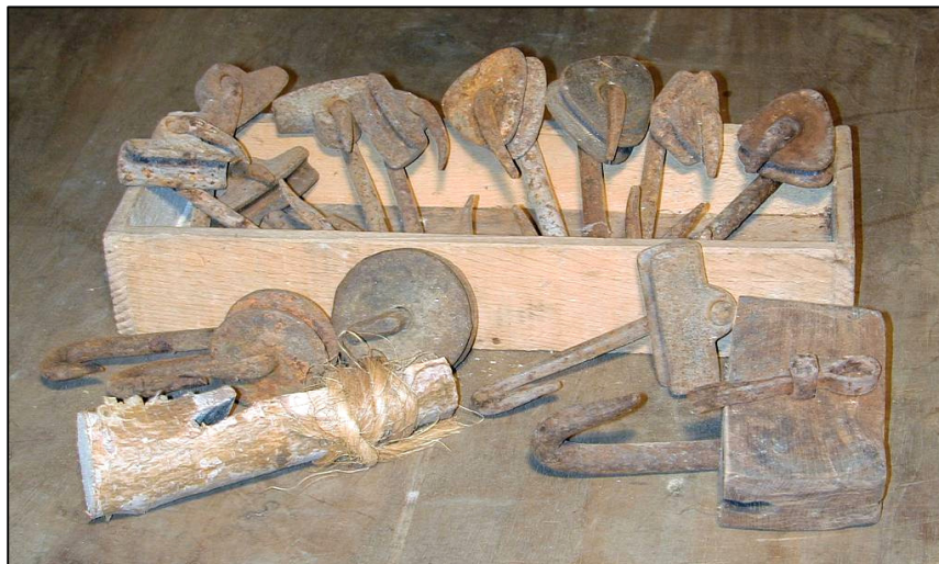
Assortimento di carrucole ( culiss ) di vario tipo utilizzate per il trasporto su filo.
