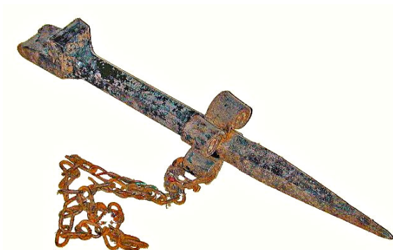
La microincudine ( tajòla ) che consentiva di correggere le irregolarità della lama della falce prima di affilarla con la cote ( cò ).
