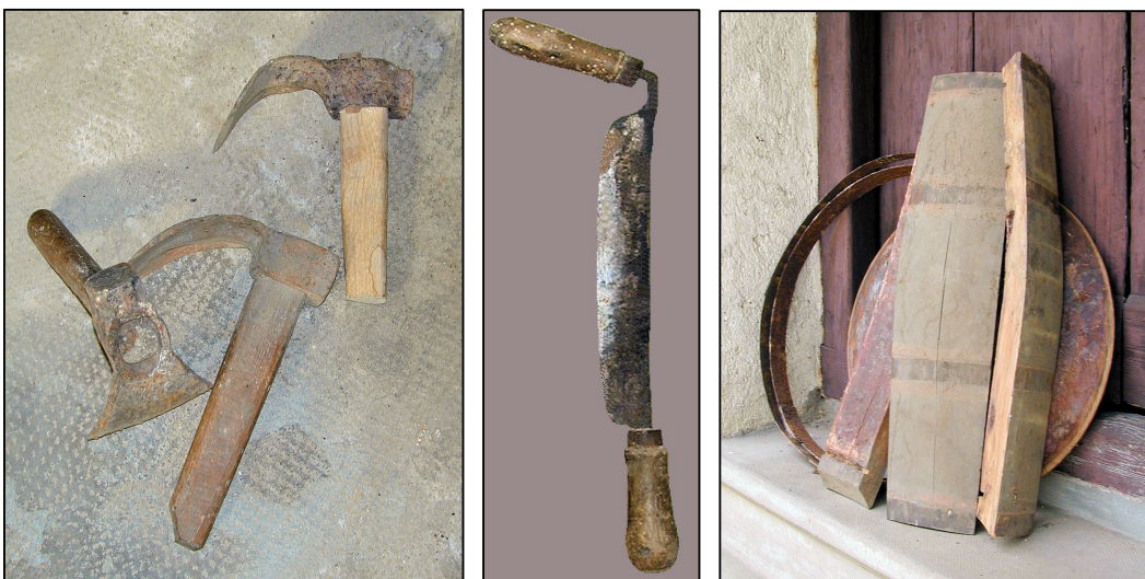
Principali attrezzi del sabrê e alcune parti della botte.
