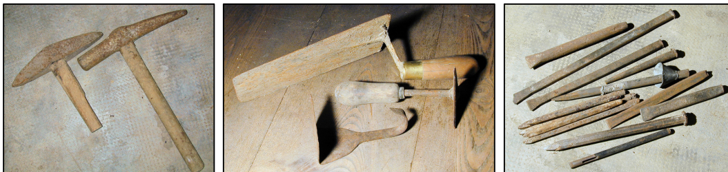
Alcuni strumenti del muratore: martello, cazzuola, raschietto e scalpelli da pietra.
