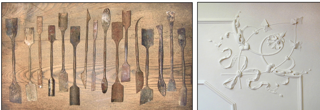
Le numerose spatole del gessatore e uno dei molti risultati della sua attività.
